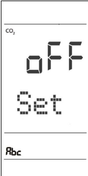
Fig. 29: Fonction de calibrage ABC (Auto Background Calibration)
