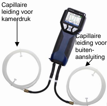
Afb. 17: Wöhler DC 410 met aangesloten capillaire slangen
