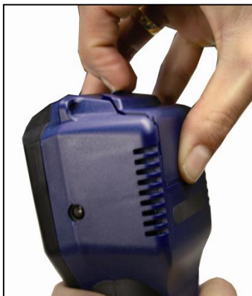
Afb. 9: Openen van het batterijenvakdeksel
