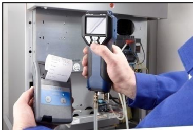
Afb. 42: : Overdracht van de meetgegevens van de DC 410 naar de thermische sneldrukker TD 600
