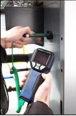
Afb. 40: Toepassingsvoorbeeld met oppervlaktetemperatuurvoeler
