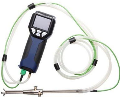
Afb. 37: Pitotbuis type S aangesloten op een Wöhler DC 410
