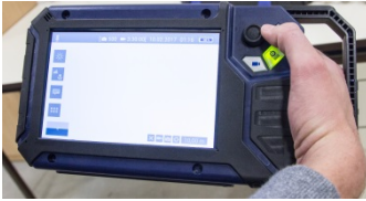
Afb. 15: Als de handgreep uitgetrokken wordt, kan de monitor met één hand vastgehouden en bediend worden.
