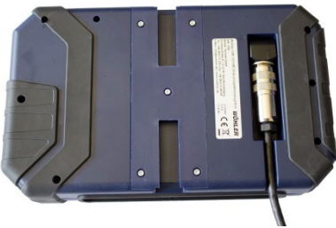
Afb. 10: Camerakabel door sleuf gelegd
