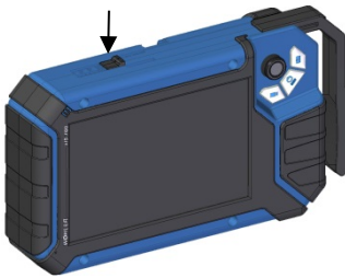
Afb. 16: Drukknop voor het uittrekken van de handgreep met pijl gemarkeerd
