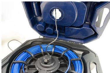
Afb. 60: Fout: camerakabel niet strak getrokken
