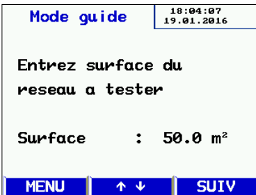
Fig. 16: Saisie la surface du réseau a tester
