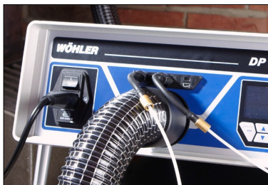
Fig. 36: Raccorder les tuyaux capillaires pour mesurer la pression différentielle
