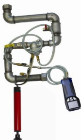
Fig. 54: Mesure de volume avec le Wöhler DC 410 FLOW et une seringue (jusqu'à 100 ml de volume)
