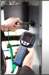
Fig. 51: Utilisation de la sonde spéciale de température de surface
