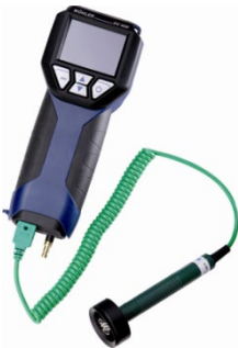
Fig. 5: Connexion de la sonde spéciale de température de surface pour la mesure du coefficient de transmission thermique.
