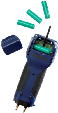
Fig. 9: Logement à batteries
