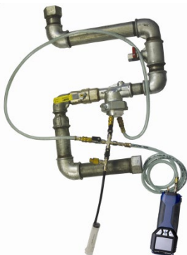
Fig. 53: Mesure de volume avec le Wöhler DC 410 FLOW et une seringue (jusqu'à 100 ml de volume)
