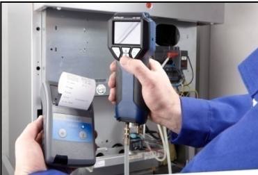
Fig. 58: Transmission de données du DC 410 FLOW vers l'imprimante thermique Wöhler TD 600.
