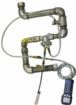
Afb. 50: Aansluitingen bij de volumemeting met de Wöhler DC 410 FLOW en spuit (tot 100 ml buisvolume)
