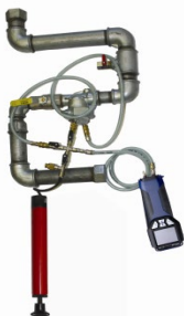
Afb. 51: Aansluitingen bij de volumemeting met de Wöhler DC 410 FLOW en roetestpomp (vanaf 100 ml buisvolume)
