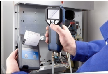
Afb. 55: : Overdracht van de meetgegevens van de DC 410 FLOW naar de thermische sneldrukker TD 600
