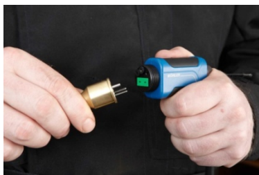
III. 10: Insertion de la sonde enfichable
