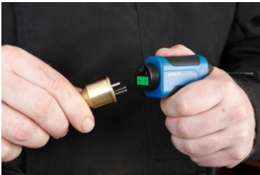
afb. 21: Inzetten van de insteeksonde
