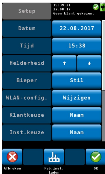
afb. 73: setupmenu; de scrollbalk laat zien, dat er nog meer subpunten ter beschikking staan.
