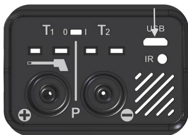
Afb. 19: USB-bus aan de onderkant van het apparaat
