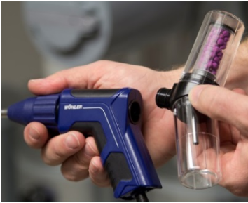
afb. 9: blokverwarmingscentrale-filter gevuld met speciaal granulaat
