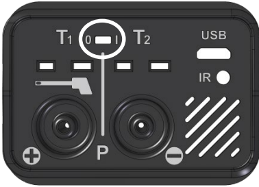
Afb. 17: vergrendelingsschakelaar naar rechts: accu geactiveerd; vergrendelingsschakelaar naar links: accu geblokkeerd
