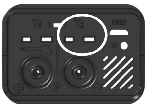
Afb. 49: temperatuurbus T_2 voor de oppervlaktetemperatuurvoeler op de onderkant van het apparaat
