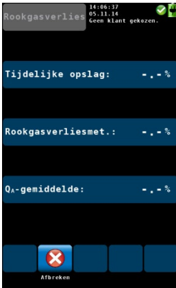
afb. 54: menupunt rookgasverlies, het apparaat heeft een rookgasverlieswaarde uit de tussentijdse opslag en het resultaat van de Q_A -gemiddelde-waardemeting overgenomen.
