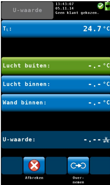
afb. 50: overname van de temperatuurwaarden voor bepaling van de U-waarde
