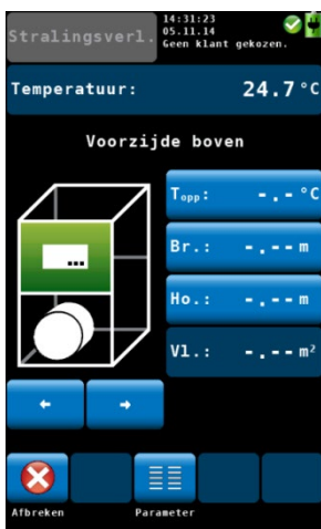
afb. 60: meet- en rekenwaarden van de voorzijde boven
