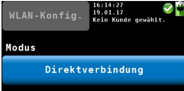
Afb. 74: WLAN-configuratie op het Wöhler A 450 afvoergasmeetapparaat, modus-keuze
