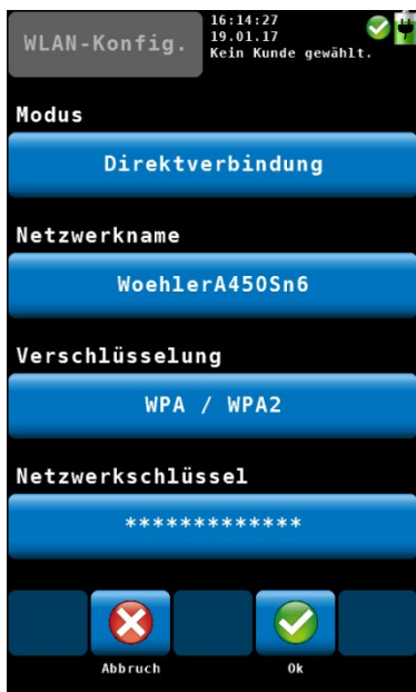
Abb. 75: configuratie directe verbinding
