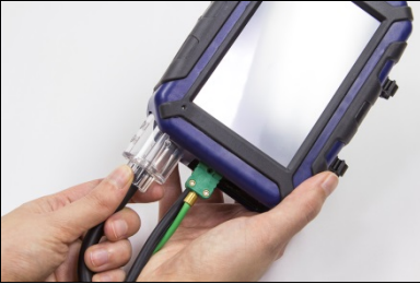
Afb. 83: condensopvang uit apparaat trekken
