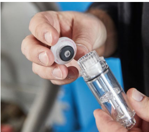
Afb. 87: waterstopfilter wordt op filterhouder gestoken
