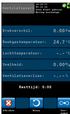
afb. 59: parameterinvoer voor de oppervlakteverliesmeting
