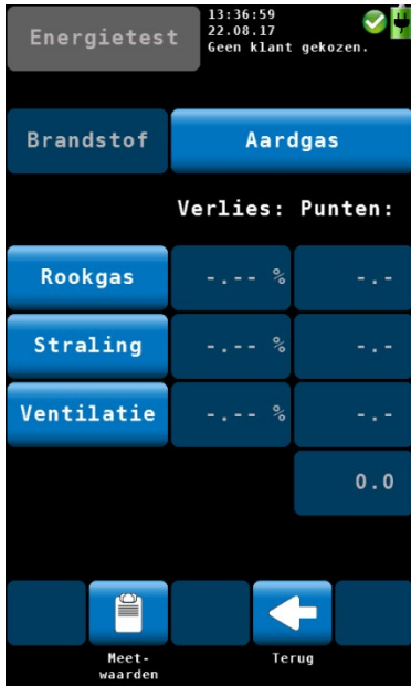
Abb. 55: Heizungs-Check – Anzeige der Verbesserungspotenzialpunkte
