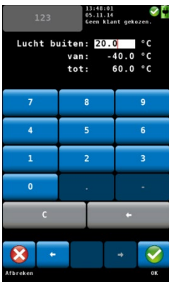
afb. 51: handmatige invoer van de temperatuur voor U-waarde-bepaling
