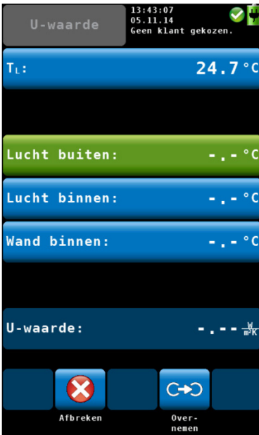
afb. 51: overname van de temperatuurwaarden voor bepaling van de U-waarde
