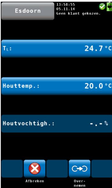
afb. 56: weergave resultaat houtvochtigheidsmeting
