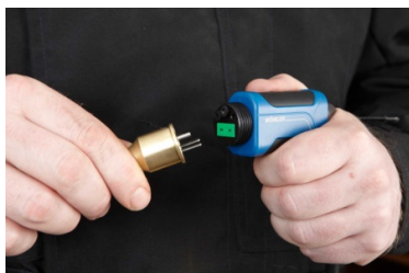
afb. 27: Inzetten van de insteeksonde
