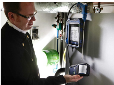
afb. 36: Afdrukken van de meetgegevens van de Wöhler A 550 op de thermoprinter Wöhler TD 100
