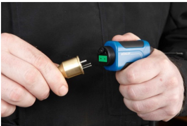
afb. 27: Inzetten van de insteeksonde
