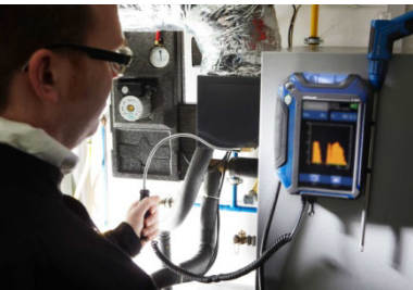
afb. 59: condens zoeken voor terugslagcontrol
