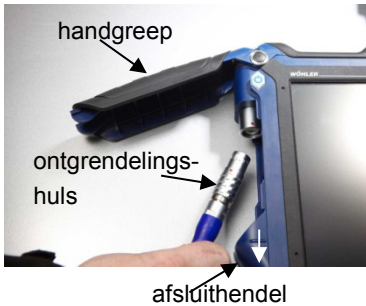
afb. 28: Wöhler A 550 met geopend sondeaansluitvak
