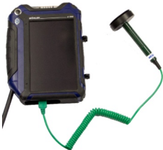
afb. 70: Wöhler A 550 met aangesloten oppervlaketemperatuurvoeler
