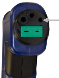
afb. 63: aansluitingen op de sondehandgreep. geleidingsbus met pijltje gemarkeerd
