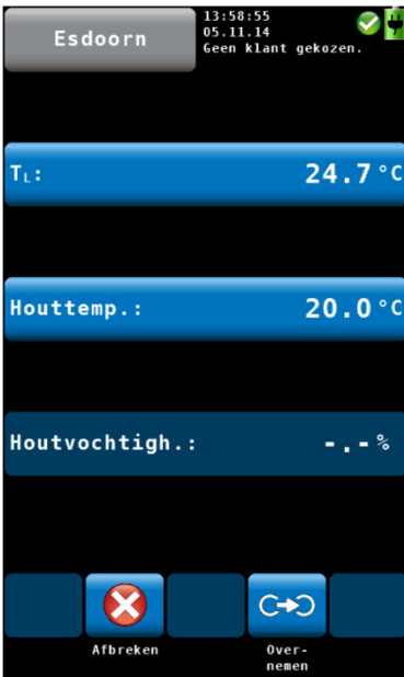
afb. 56: weergave resultaat houtvochtigheidsmeting
