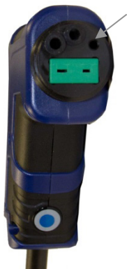
afb. 44: aansluitingen op de sondehandgreep. geleidingsbus met pijl gemarkeerd (alleen Wöhler A 550)
