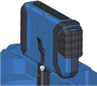
Fig. 63: Appuyez sur le levier et tirez le moniteur hors de son support.
