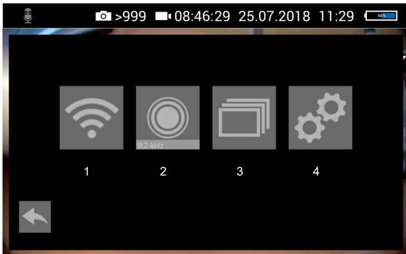
Fig. 32: Menu du système avec les sous menus WLAN (1), localisation (2), galerie de photos et vidéos (3) et paramètres (4)
