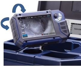
Fig. 13: Le moniteur peut pivoter et basculer.
