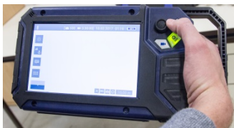
Fig. 16: Lorsque la poignée est déployée, le moniteur peut être tenu et actionné d'une seule main.
